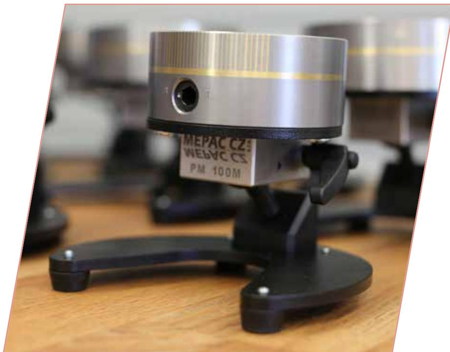
Наклонно-поворотные магнитные держатели серий РМ (стандартная) и РМЗ (усиленная) разработаны специально для ремонта и обслуживания пресс-форм и их компонентов. Магнитный патрон позволяет полностью отказаться от механического крепления обрабатываемой детали, оставляя доступ к ней совершенно свободным. Для закрепления держателя на рабочем столе используются встроенные зажимы.
